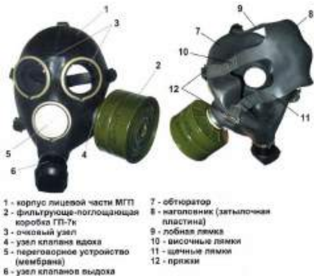
Рис. 5 — Устройство противогаза (на примере ГП-7)
